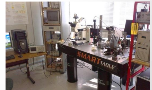
Microscopie interférométrique en lumière blanche.
